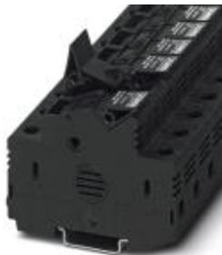
Sicherungsreihenklemme, Art der Sicherung: Glas / Keramik / ..., Anschlussart: Schraubanschluss, Querschnitt: 1,5 mm<sup>2</sup>- 25 mm<sup>2</sup>, AWG: 16 - 3, Nennstrom: 30 A, Nennspannung: 1000 V, Breite: 18 mm, Sicherungstyp: 10,3 x 38 mm, Montageart: NS 35/7,5, NS 35/15, Farbe: schwarz
