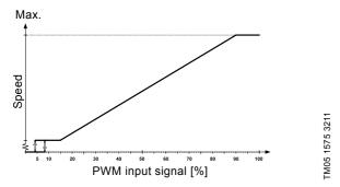
Fig. 48 PWM input profile C
