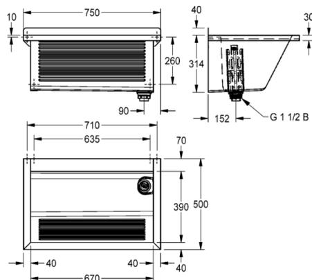
SIRIUS Waschtrog für Wandmontage, Chromstahl, Oberfläche hochglanzpoliert, Materialstärke Waschtrog 0,8 mm / Seitenpaneele 1,2 mm, Seitenpaneele mit integrierten Wandkonsolen, fugenlos verschweißt, Frontschürze mit Längsrieffel, abgesenkte Armaturenbank 70 mm, ohne Überlauf, 40 mm Wandzarge, Ablauf rechts, Standrohrventil G 1 1/2 B aus Kunststoff, entnehmbares Eckschutzblech, inklusive Befestigungsmaterial.
