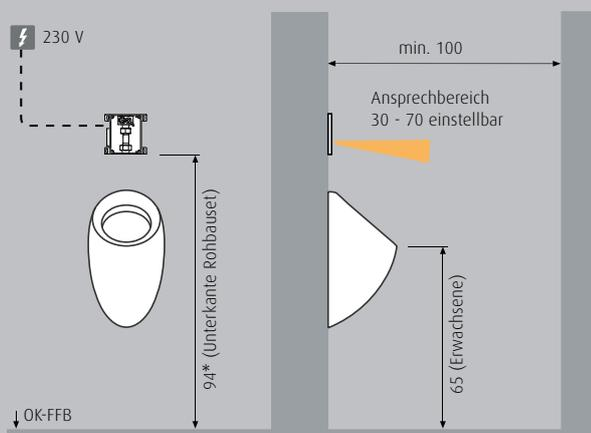
Bei 230 V Netzbetrieb Elektro-Leerverrohrung vorsehen.
