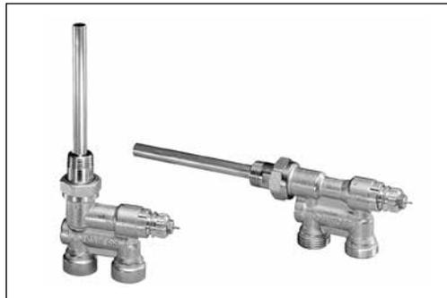
RA 15/6T und RA 15/6TB sind spezielle Lanzenventilgehäuse, die den Heizkörperanschluss an nur einem Anschlusspunkt, wahlweise seitlich oder unter dem Heizkörper, ermöglichen.
