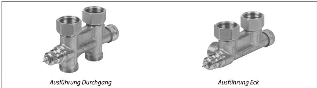
Die Universal-Anschlussarmatur VHS ist für Heizkörper mit einem unteren Anschluss von 50 mm einsetzbar, z.B. für Bad- und Designheizkörper. VHS\* für Zweirohrsysteme kann mit den RA-, RAX-, RAW-, living eco®, living connect®- und RAW-Fühlern, den Ferneinstell-elementen oder den elektrischen Stellantrieben TWA kombiniert werden.
