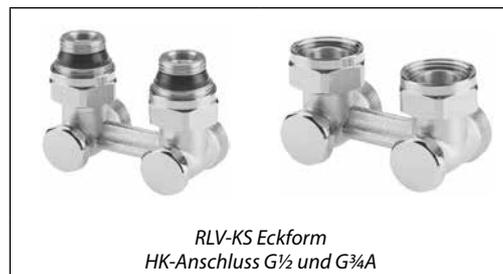
Mit Hilfe der Universalverschraubung Typ RLV-KS kann jeder Ventilheizkörper mit einem Mittenabstand der Anschlussstutzen von 50 mm individuell abgesperrt werden, um z.B. Wartungsarbeiten problemlos und ohne Beeinträchtigung der Anlage durchführen zu können.
