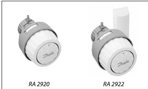
Die Fühler passen zu allen RA-Ventilgehäusen. Beide Fühlerelemente verfügen über eine Frostschutzfunktion und sind begrenzen- oder blockierbar. Der Fernfühler enthält 2 m Kapillarrohr. Bei der Befestigung verbleibt nicht benötigtes Kapillarrohr aufgerollt im Fühlerkasten und ist deshalb nicht sichtbar.
