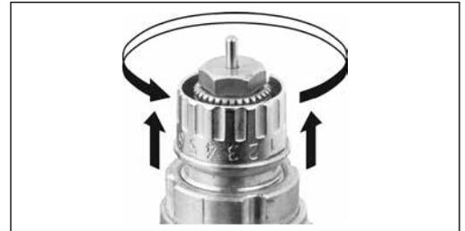
Die Voreinstellung kann in Stufen von 0,5 zwischen 1 und 7 gewählt werden. Bei Einstellung N ist die Voreinstellung aufgehoben (Spülmöglichkeit und Inbetriebnahmestellung).
