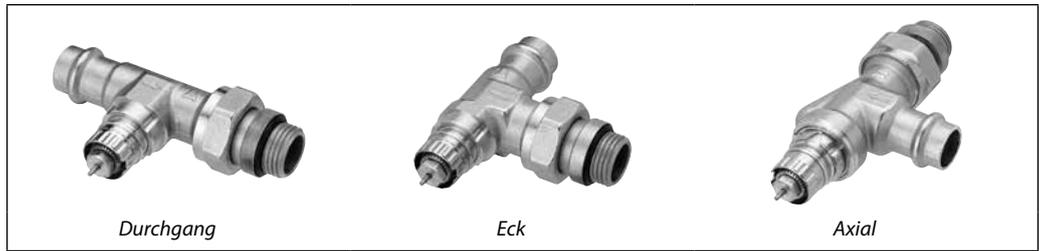
Die Ventilgehäuse RA-N mit Pressfit-Anschluss sind für Anlagen mit Edelstahl-, Kupfer- und C-Stahlrohren geeignet. Die rohrseitige Anbindung lässt sich mit handelsüblichen Presswerkzeugen schnell und sicher durchführen, selbstdichtende Nippel vereinfachen die heizkörperseitige Anbindung.
