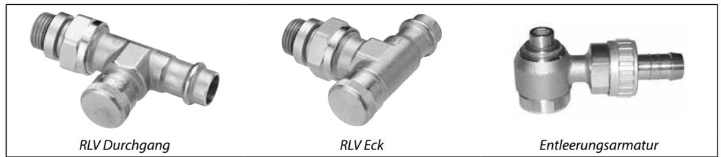
Ventilgehäuse RLV mit Pressfit-Anschluss sind für Anlagen mit Edelstahl-, Kupfer- und C-Stahlrohren geeignet. Die rohrseitige Anbindung lässt sich mit handelsüblichen Presswerkzeugen schnell und sicher durchführen, selbstdichtende Nippel vereinfachen die heizkörperseitige Anbindung.
