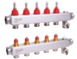
**Fußbodenheizungsverteiler SSM mit Durchflussanzeige aus Edelstahl, mit integrierten voreinstellbaren Danfoss Ventileinsätzen im Rücklauf, Abstand 50 mm, mit Durchflussanzeige im Vorlauf, absperrrbar und voreinstellbar, zur Aufnahme von thermischen Stellantrieben TWA -A im Rücklauf, Heizkreisanschlüsse 3/4" AG PN 6 mit manuellem Entlüftungsventil und KFE-Hahn**
