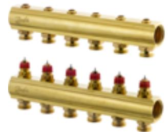
**Fußbodenheizungsverteiler mit Durchflussanzeige aus Messing, mit integrierten, voreinstellbaren Danfoss-Ventileinsätzen im Rücklauf, Abstand 50 mm, mit Durchflussanzeige im Vorlauf, absperbar und voreinstellbar, zur Aufnahme von thermischen Stellantrieben TWA-A im Rücklauf, Heizkreisanschlüsse 3/4" AG, PN 6**
