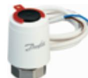
**Thermischer Stellantrieb für weitere Fabrikate mit Anschluss M30 x 1,5 AG (z.B. Heimeier, Oventrop und MNG Standardventile), mit Stellungsanzeige (kein Adapter erforderlich), ohne Handverstellung, max. Umgebungstemperatur 50°C, Leistungsaufnahme 2 Watt, andere Hersteller auf Anfrage**
