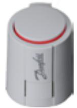
**Elektrothermische Stellantriebe Typ ABN-FBH für Fußbodenheizung (ohne Adapter), Kabellänge 1,0 m, Steckbare Ausführung mit Schnappbefestigung, Funktionskontrolle, Stellungsanzeige und 360° Montagelage, Leistungsaufnahme 1 Watt**
