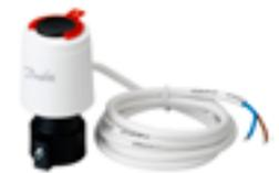
**Thermischer Stellantrieb für Danfoss Verteiler FHF und SSM, mit Stellungsanzeige, ohne Handverstellung, Kabellänge 1,2 m, max. Umgebungstemperatur 50 °C, Leistungsaufnahme 2 Watt**
