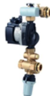
**Kompakt-Mischerguppe FHM für Fußbodenheizung, mit Umwälzpumpe, Konstanttemperaturregelung durch selbsttätigen Regler, Thermometer 0 - 60 °C im Vorlauf, Entlüftungsventil manuell, Rückflussverhinderer, Anschluss Primärseite 1/2", Anschluss Sekundärseite 1", für die Montage im Verteilerschrank geeignet. Anmerkung: Passender Verteiler / Halter: siehe Danfoss Verteiler, Messing siehe Seiten 115 und 117**
