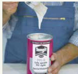
7. Fließt der Klebstoff nicht mehr ab, darf Tangit nicht mehr eingesetzt werden. Tangit Klebstoff ist mind. 2 Jahre ab Abfülldatum haltbar.
