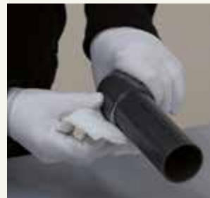
11. Überschüssigen Klebstoff mit Fließpapier entfernen.
