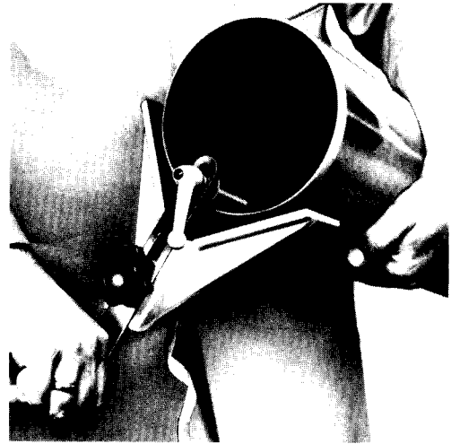
Bild 2: Anschrägen der Rohre
