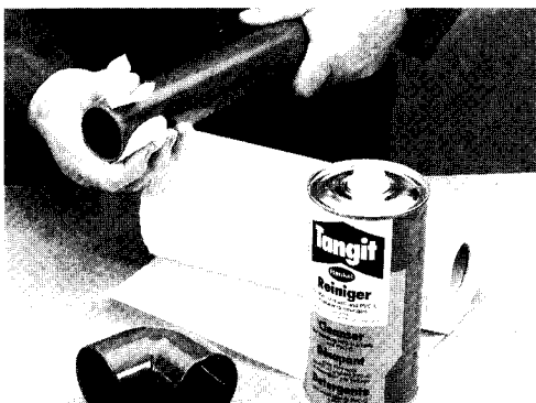
Bild 5: Reinigen von Rohr und Muffe
