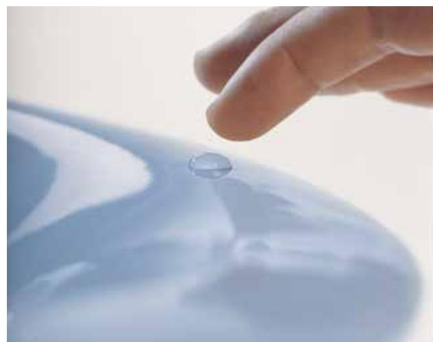
LCC est l'abréviation de la désignation **Laufen Clean Coat**. Ce traitement innovant de la surface céramique consiste en un revêtement céramique à base de silicate vitreux cuit sur le vernis d'origine. Le revêtement LCC fait partie intégrante de la céramique et en tant que tel, est extrêmement résistant et pratiquement inusable.
