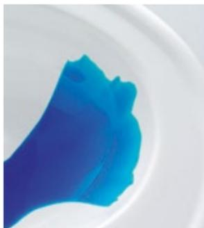
Abflussverhalten von Flüssigkeiten auf einer herkömmlichen Keramikoberfläche.
