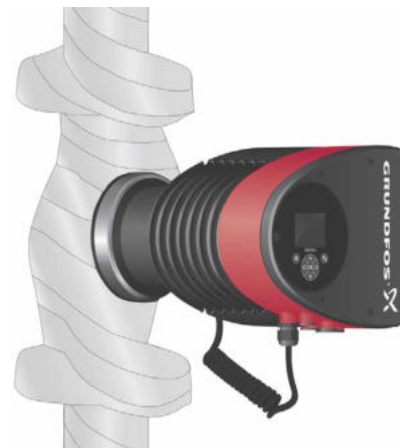
Obr. 4 Izolácia telesa čerpadla a potrubia
