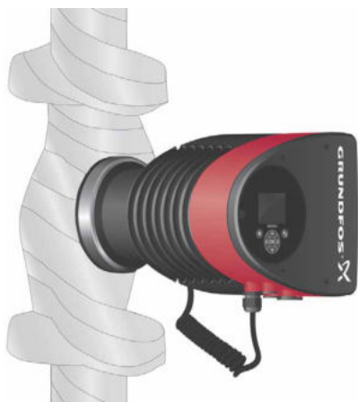
Slika 4 Izolacija kućišta crpke i cjevovoda
