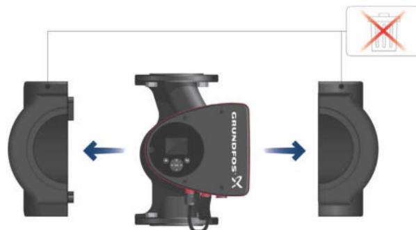
Fig. 3 Montering af isoleringsskaller på pumpen
