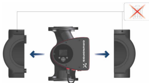
Fig. 3 Montaggio gusci isolanti sulla pompa.
