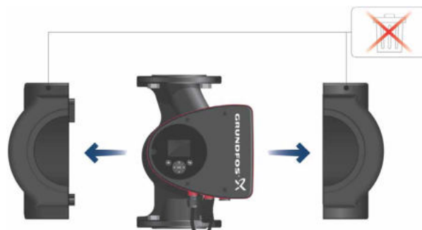
Σχ. 3 Τοποθέτηση μονωτικών κελυφών στον κυκλοφορητή
