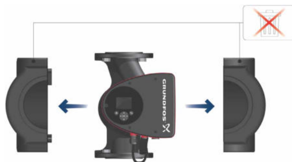
Rys. 3 Montaż okładzin termoizolacyjnych na pompie
