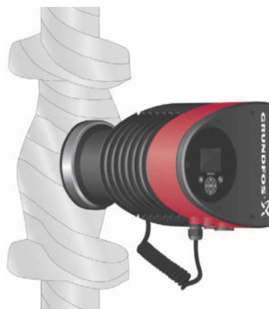
Fig. 4 Isolering av pumphus och rörnät
