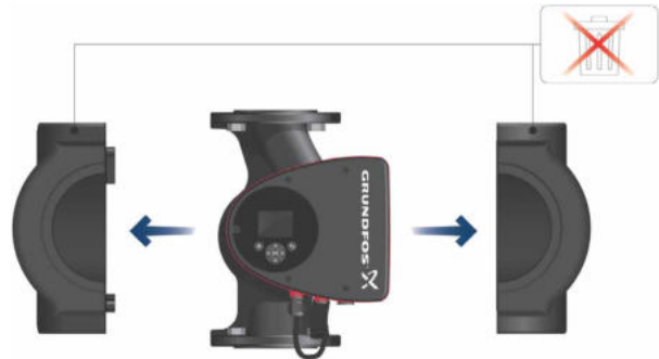
图 3 给泵安装绝缘外壳
