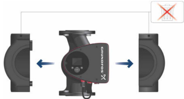
Kuva 3 Lämpöeristysvaippojen asennus pumppuun
