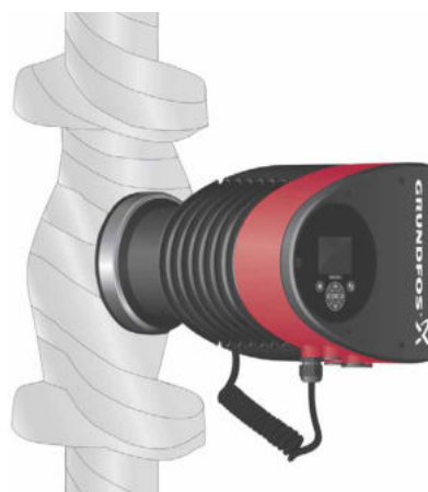
Фиг. 4 Изолиране на помпения корпус и тръбите
