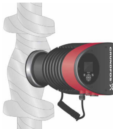
Fig. 4 Izolarea carcasei pompei și a conductelor
