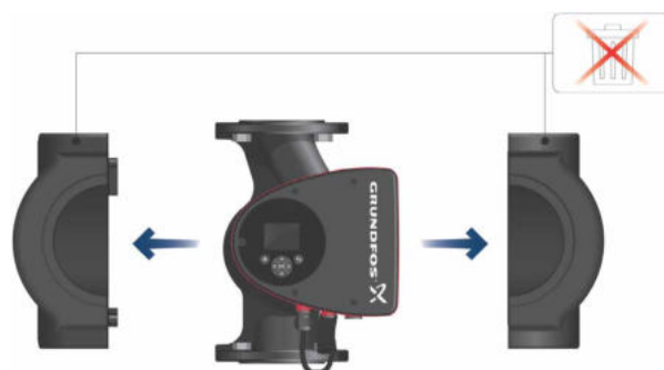
Fig. 3 Montaje de las carcasas aislantes en la bomba
