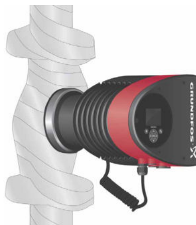
Rys. 4 Izolacja korpusu pompy i rurociągu
