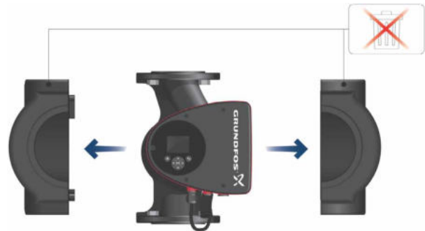
Obr. 3 Inštalácia tepelno-izolačných krytov na čerpadlo
