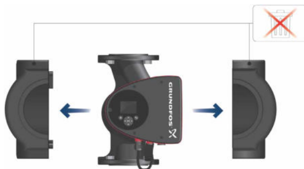
Рис. 3 Установка теплоизоляционного кожуха на насос
