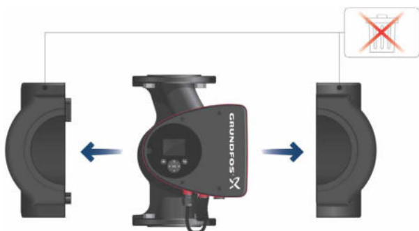
Slika 3 Postavljenje izolacione zaštite na pumpu
