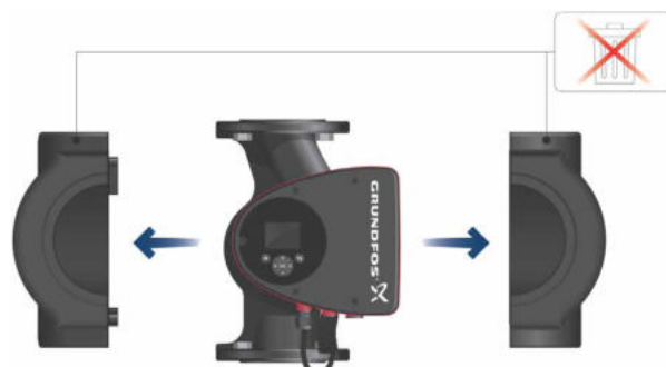
3 pav. Izoliacinių kevalų uždėjimas ant siurblio
