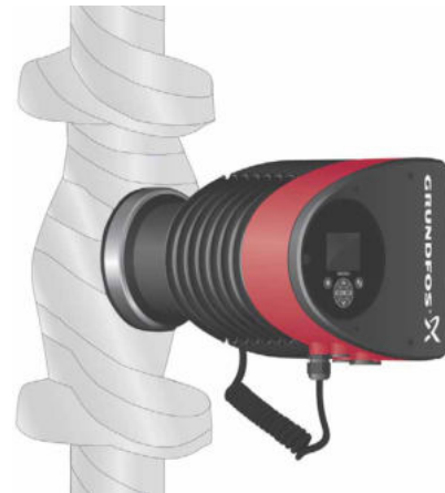
Kuva 4 Pumppupesän ja putkiston lämpöeristys
