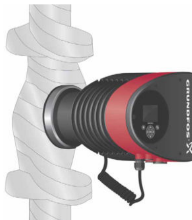
Рис. 4 Ізоляція корпусу насоса та трубопроводу.
