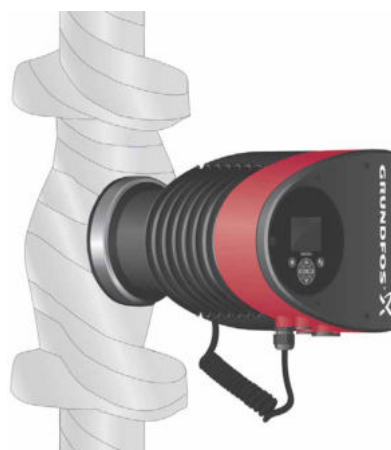
Fig. 4 Aislamiento de la carcasa de la bomba y de las tuberías
