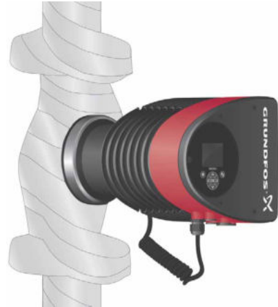
Şekil 4 Pompa gövdesinin ve boru tesisatının yalıtımı
