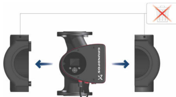
Fig. 3 Installation des coquilles d'isolation
