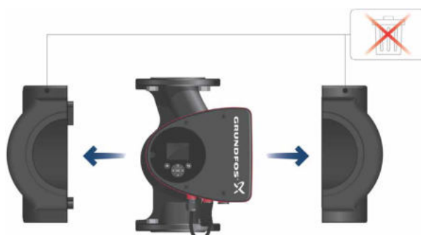
Fig. 3 Montering av isoleringskåpor på pumpen
