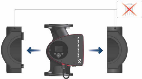
Obr. 3 Instalace tepelně-izolačních krytů na čerpadlo
