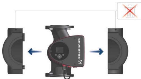
Afb. 3 Aanbrengen van isolatiemantels op de pomp
