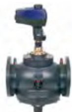
AME/V 435 QM Getriebemotor zur Ansteuerung mit 3-Punkt oder stetigem 0-10 V-Signal von AB-QM 40-100
