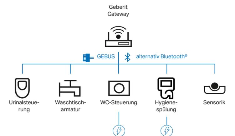
Bis zu 30 Geberit Endgeräte mit Geberit Connect Funktion können via Geberit Buskabel mit einem Geberit Gateway verbunden werden. Per Funkverbindung können zehn Teilnehmer angebunden werden. Das Geberit Gateway dient gleichzeitig als Stromquelle für die Urinalsteuerung und Waschtischarmatur.
