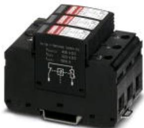
Blitzstrom- / Überspannungsableiter für 2-polige isolierte Gleichspannungssysteme 1000 V DC, für Tragschienenmontage, 3-poliges Basiselement, drei steckbare temperaturüberwachte Schutzelemente, Statusmeldung an jedem Stecker.
