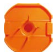
Signaldeckel mit Kunststoffborsten zum besseren Auffinden, Ausformung ermöglicht das Zentrieren des Hartmetallfräasers zum Ausbohren der Putzschicht, Ausbrechen des Putzes verhindert.
