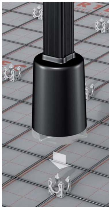
Das **FLOORTEC Gittermattensystem** wird unabhängig vom darunter befindlichen Dämmungsaufbau ausgeführt. Über der Abdeckfolie wird die Gittermatte verlegt und das Rohr mit so genannten Gittermattenclips darauf befestigt. Die Gittermatten werden mit Mattenverbindern zu einer einheitlichen Fläche zusammengefügt.
