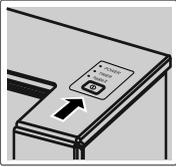
1. Drücken Sie die Taste einmal, um den Automatikbetrieb zu nutzen.
