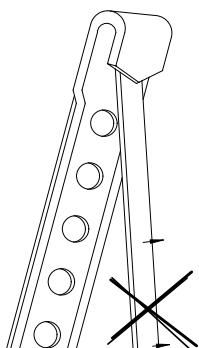
**SICHERHEITSTEIL** Einhängehaken wegen Bruchmöglichkeit nicht verbiegen und mit 2 Originalschrauben M10x16 8.8 mit einem Anzugsmoment 40 bis 50 Nm befestigen.
